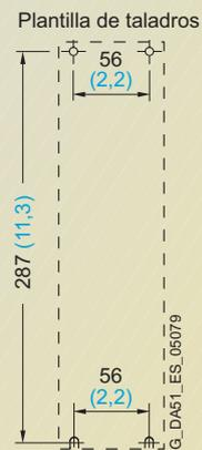
Fijación con tornillos M4
