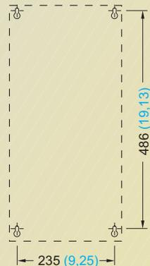
Fijación con 4 tornillos M8, 4 tuercas M8, 4 arandelas M8
