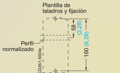
Fijación con 2 tornillos M4, 2 tuercas M4, 2 arandelas M4 o abrochado en perfil
