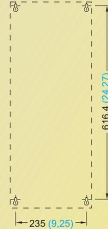
Fijación con 4 tornillos M8, 4 tuercas M8, 4 arandelas M8
